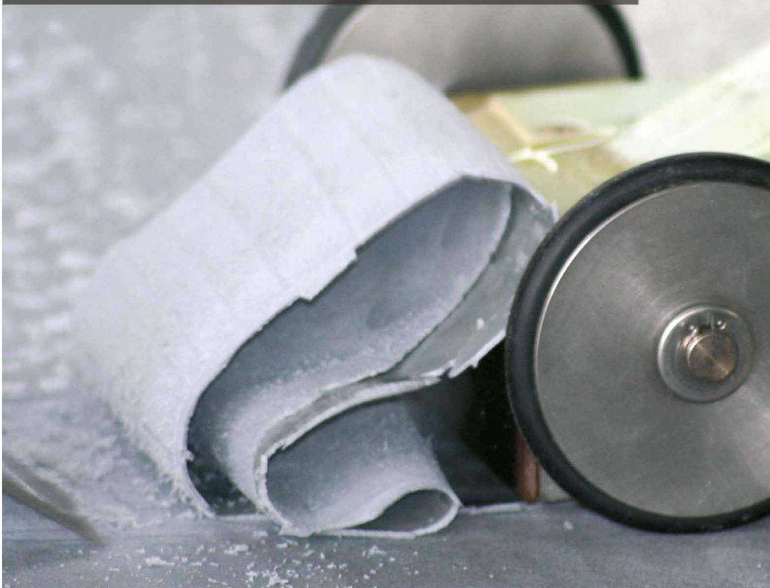
Das innovative OFTEC-RPR-System ist eine effektive und effiziente Methode zum Entfernen von Korrosionsprodukten (Farben, Epoxide, Brandschutzfarben, Dickschichtbeschichtungen, etc.) von metallischen Oberflächen. Dieses emissionsarme Verfahren ist auch besonders gut für die Entfernung kontaminierter Oberflächen geeignet.
